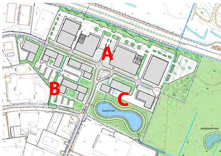
Figur 18. Strukturplan med 3 delområden som avses exploateras: A, B och C – Förslag/preliminärt koncept för områdets exploatering (okt 2024) Observera att gröddammen i kartbilden visar ett ungefärligt läge och storlek. Gröddammar och övriga skyddsåtgärder kommer att placeras nära befintligt dike för att säkerställa vattentillgången i dammarna.
