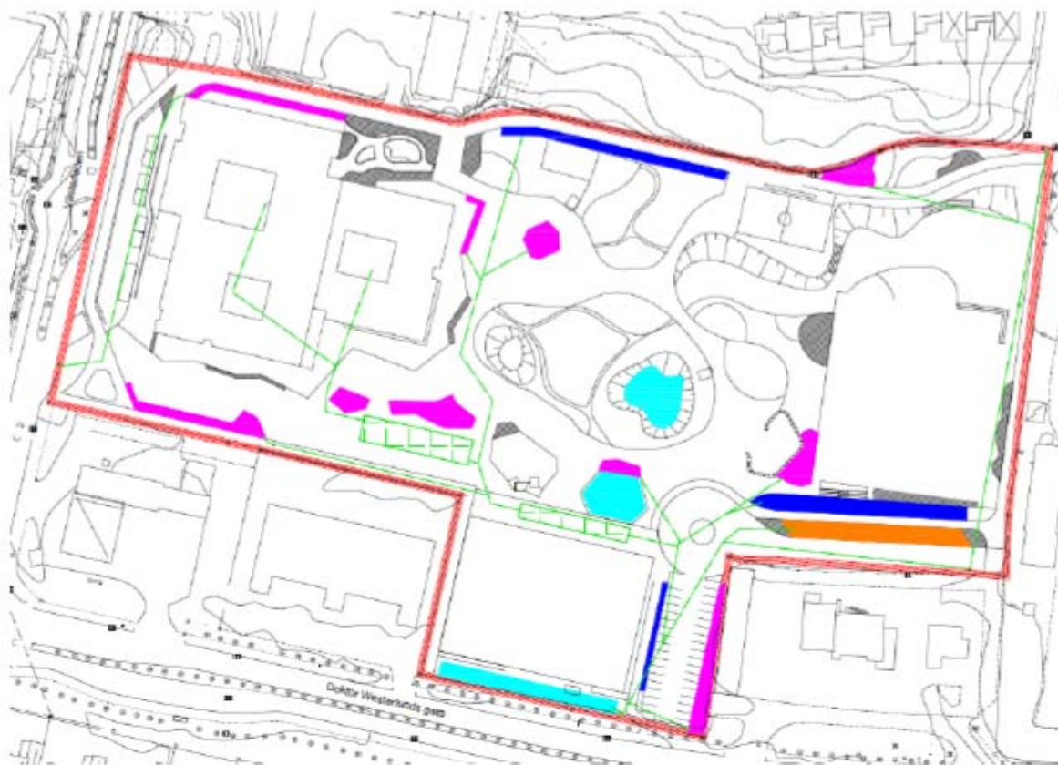
Figur 10. Kartan visar fördörjningsförslag inom det rödmarkerade planområdet. Ytor där det föreslås fördörjning i växtbäddar/biofilter är magentamarkerade. Ytor där skelettjord föreslås för fördörjning är mörkblåmarkerade. En makadamfördörjning under gräsarmering är ritat i orange samt översvämningssytor i cyan. Föreslagna dagvattenledningar att koppla ihop fördörjningar och leda dagvatten till befintliga anslutningspunkter är grönmarkerade.
