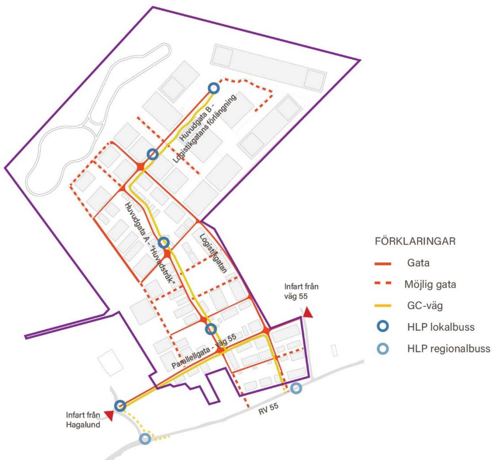
Bild 50. Pictogram över strukturplanens vägnät och möjliga lägen för gång- och cykel samt kollektivtrafik. Tyréns, 2023. Funktionerna har tydliggjorts på en tidigare version av strukturskissen. Lägen för hållplatser oc anslutning till rv 55 behöver samrådats kring, liksom gatunätets struktur i detalj.
