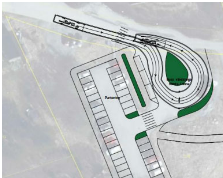
Bild hämtad ur trafikutredningen (figur 7 sid 14) som visar hur vändzonen skulle kunna anordnas för att inrymma parkeringsplatser. Körspår "normalbuss" har använts.
